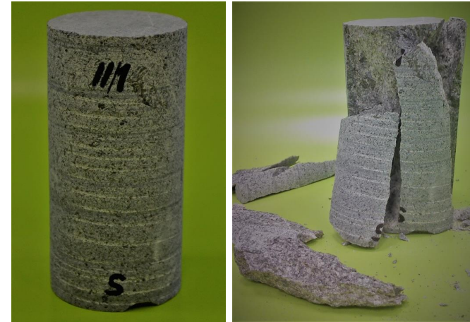
Fot. 2. Próbkę laboratoryjne o smukłości s=2 (po lewej) oraz zniszczona próbka po badaniu (po prawej)
